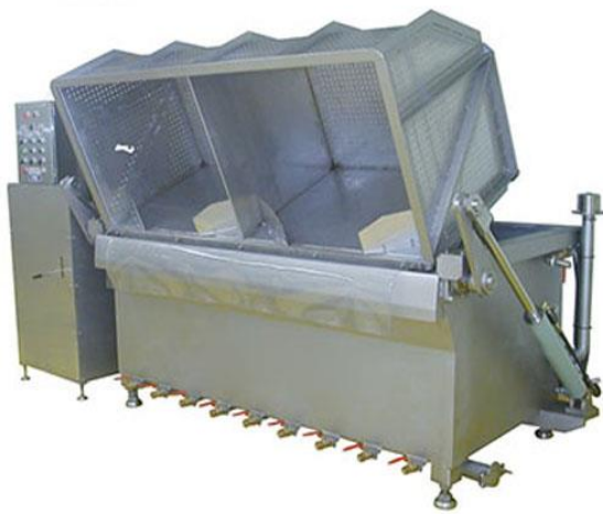
شکل ۱) نمونه هایی از دستگاه های انجماد زدا با استفاده از آب ۲۱
