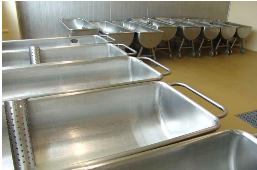
شکل ۴) انجماد زدایی بوسیله آب متحرک در مخازن استیل
